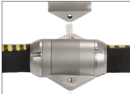
Der Zentrier Werkzeugsatzes muss so festgezogen werden, dass die Steigung an der Hinterkante der einzelnen Stellen der Schneideinheit sich an den einzelnen Blöcken fortsetzt.
