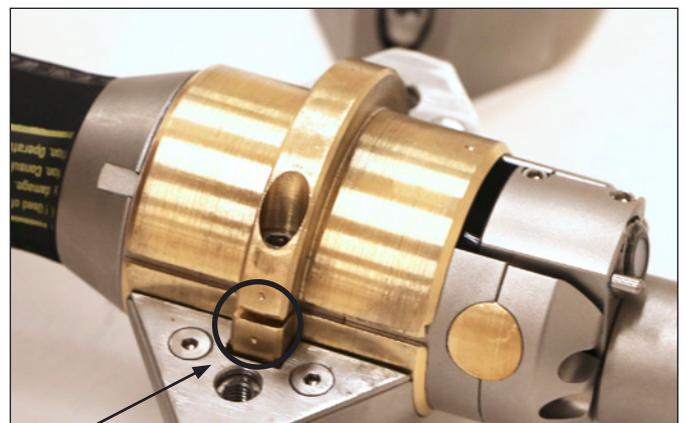
Stellen Sie den Fräser unter die drei Zentrierringe, so dass der rotierende Donutsring dicht am Grinder platziert ist.
