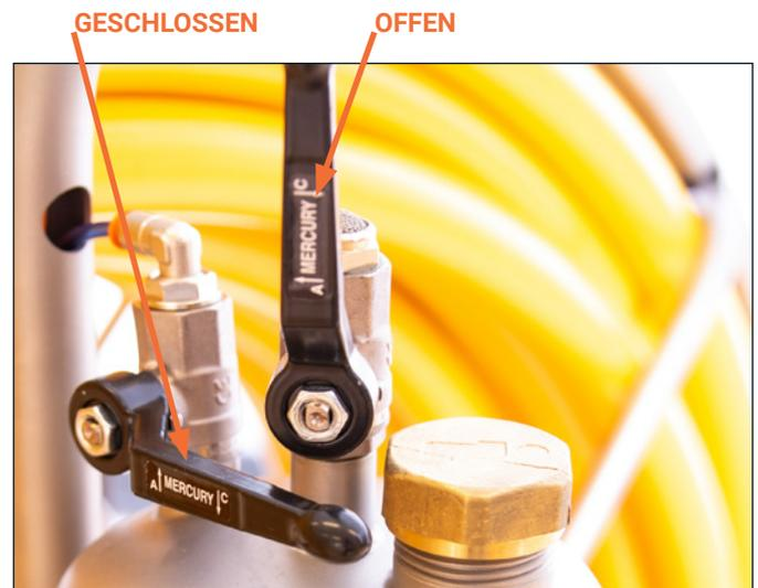
geöffnet und die Entlüftung geschlossen wird.
