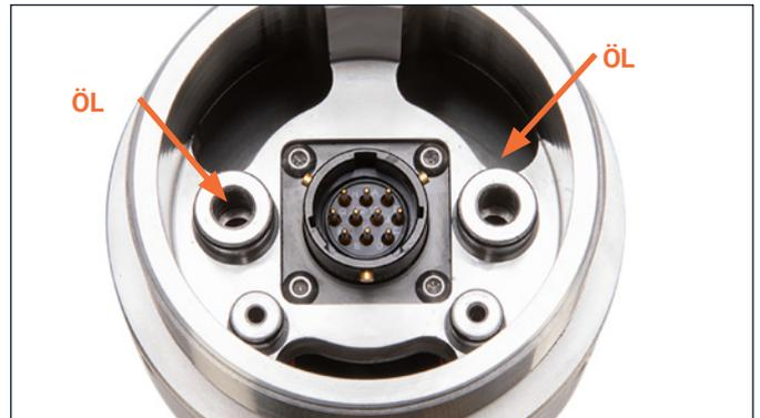
4. Gießen Sie ein wenig Pneumatiköl in den Lufteingang des Luftmotor und pusten Sie mit einer Druckluftpistole, bis das Öl aus der Luftmotor austritt.
