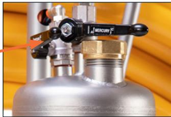
Schließen Sie nun die Druckluftleitung der Kompressoreinheit an die kombinierte Wasserabscheide-/Ölschmierreinheit des Schlauchhaspel des Fräasers an („3“ in der Abbildung unter Punkt 7.1.1).
