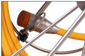
Legen Sie den Fräser vor den gelben Schlauch und schrauben Sie die beiden orangen Schutzkappen ab. Schieben Sie die beiden Enden zusammen und schrauben Sie die Überwurfmutter des gelben Schlauchs zum Fräser hin fest zusammen.
